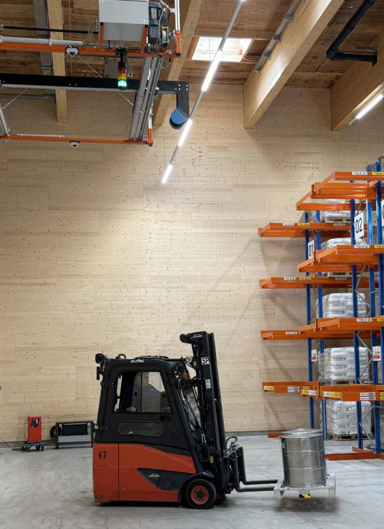
Vor der automatisierten Einlagerung werden Paletten und Ladungsträger an der Konturenkontrolle vermessen und für den weiteren Materialfluss freigegeben.
