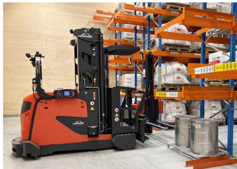
Nach erfolgreicher Konturenprüfung erzeugt das System automatisch die nächsten Transport- und Einlagerungsmissionen für das FTS.
